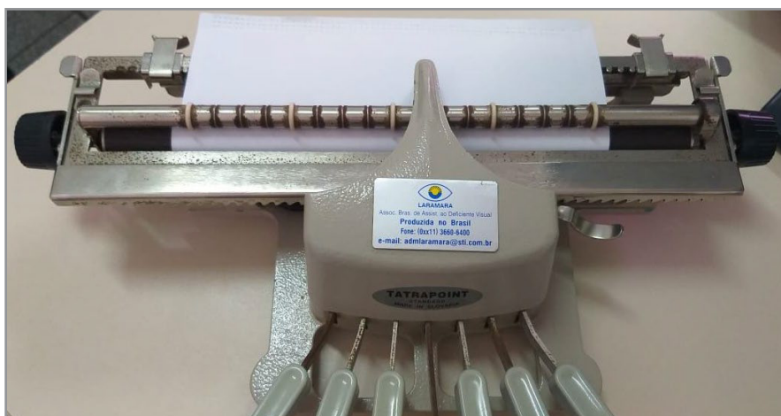
Figura 2 – Máquina Tatrapoint de escrever em braille
