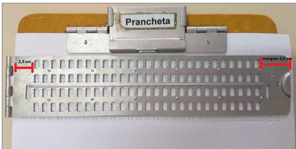
Figura 3 – Reglete tradicional de metal com prancheta
